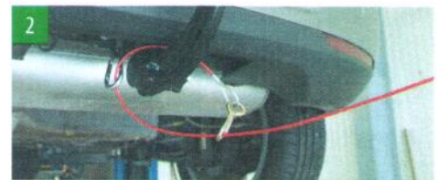
Fädeln Sie den Federhaken durch den in die Sicherungsöse / Langlochbohrung eingeklinkten Feuerwehrkarabiner (DIN 5299, L: mind. 70 mm); Dann formen Sie noch – wie bei 1 – die Schlaufe und klinken am Seil ein.
