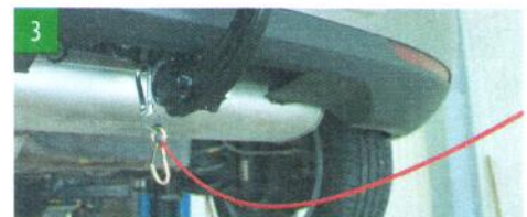
Anstelle des Original-Federhakens am Seil nutzen Sie einen Feuerwehrkarabiner (DIN 5299, L: mind. 70 mm) und klinken diesen direkt (ohne Schlaufe um den Kugelhals) in die Sicherungsöse / Langlochbohrung ein.
